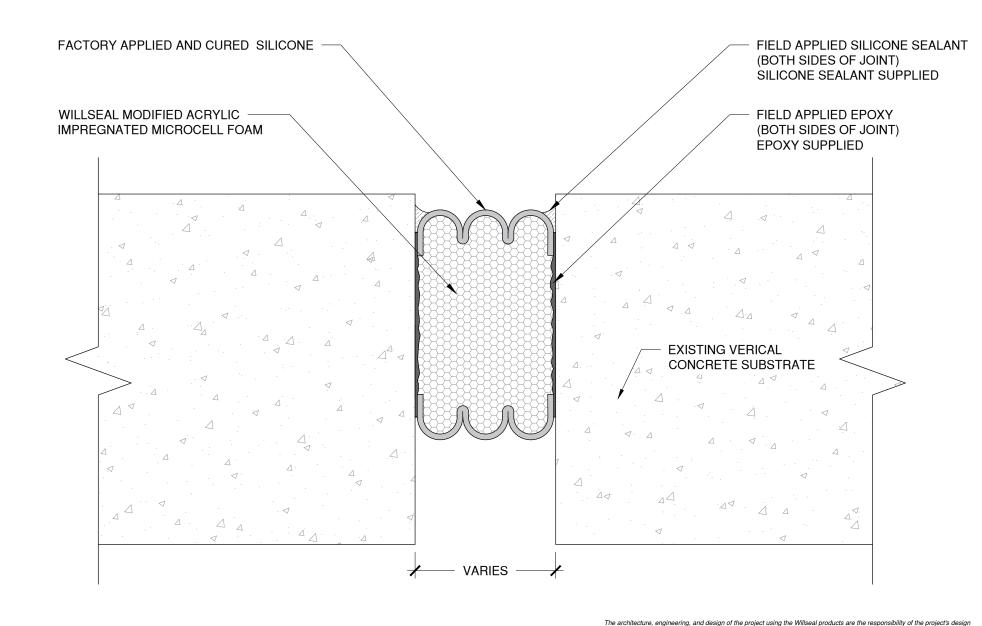
NOTE: RECESS JOINT  $\frac{1}{4}$ " FROM JOINT SURFACE.
