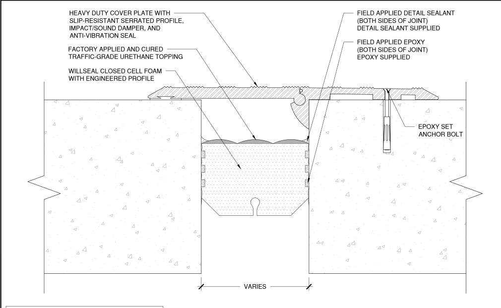
NOTE: RECESS JOINT 1- $\frac{1}{4}$ " FROM JOINT SURFACE.
