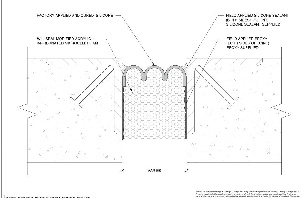
NOTE: RECESS JOINT  $\frac{1}{2}$ " FROM JOINT SURFACE.
